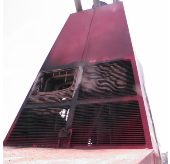
Εικόνες 12 και 13: Καταστροφή από τήξη του αλουμινένιου περιβλήματος της καπνοδόχου του πλοίου.
