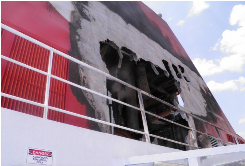
Εικόνες 12 και 13: Καταστροφή από τήξη του αλουμινένιου περιβλήματος της καπνοδόχου του πλοίου.
