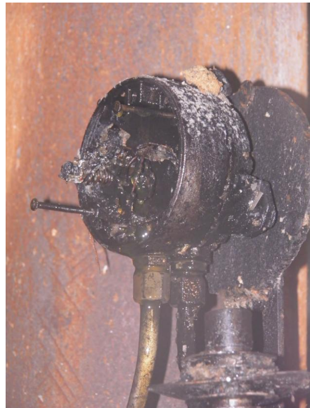
Εικόνα 18: Η διαρροή από το όργανο παρακολούθησης ροής θερμαντικού ελαίου από τον οικονομητήρα No. 4.
